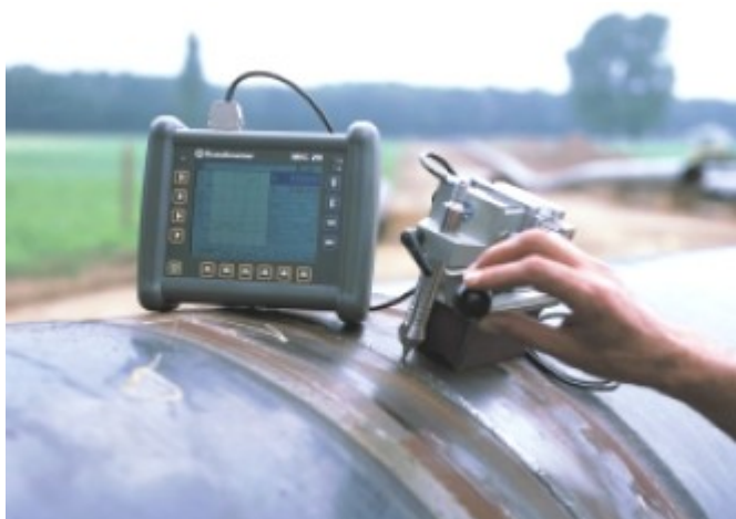
Рис. 1. Испытание на твердость с использованием MIC 20 и штативом MIC227 и УЗ зондом в ЗТВ сварного шва.
