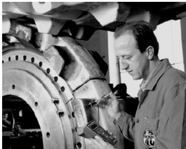
Рис. 2. Испытание на твердость с твердомером по методу отскока на ведущем колесе большого гидравлического экскаватора.
