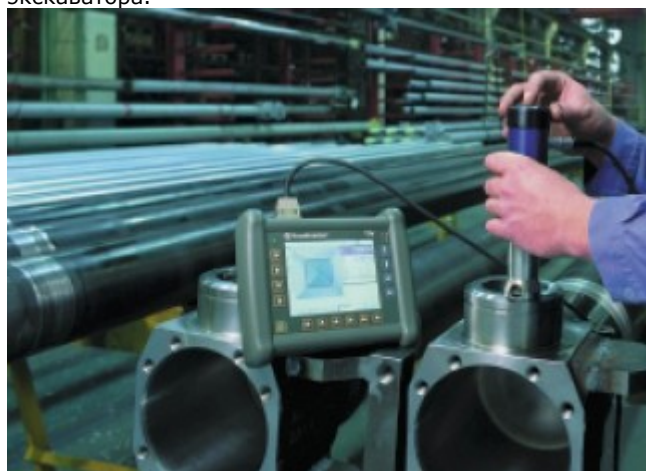
Рис. 4. Испытание на твердость с оптическим твердомером модели TIV.
