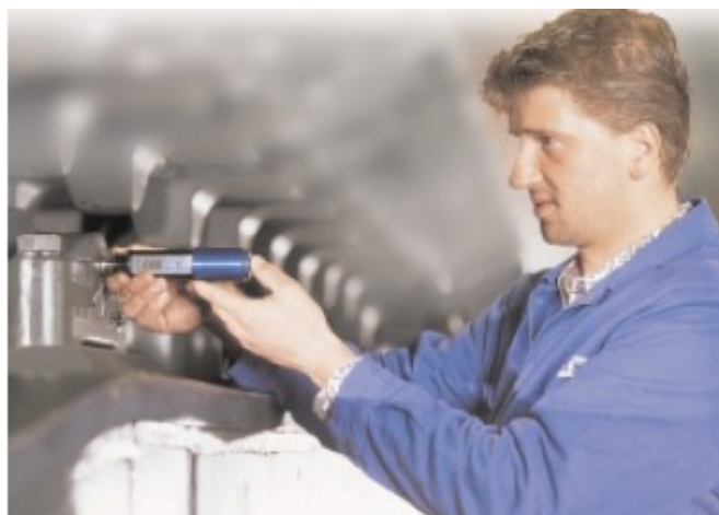
Рис. 3. Испытание на твердость с прибором модели DynaROCKET.
