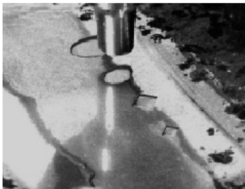
Рис. 21: Испытание на твердость в зоне температурного воздействия (ЗТВ)
